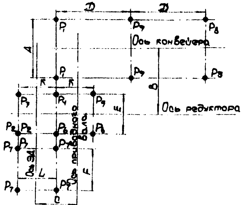
Рис.60. Схема распределения нагрузки на опоры от конвейера типа КСВ6
